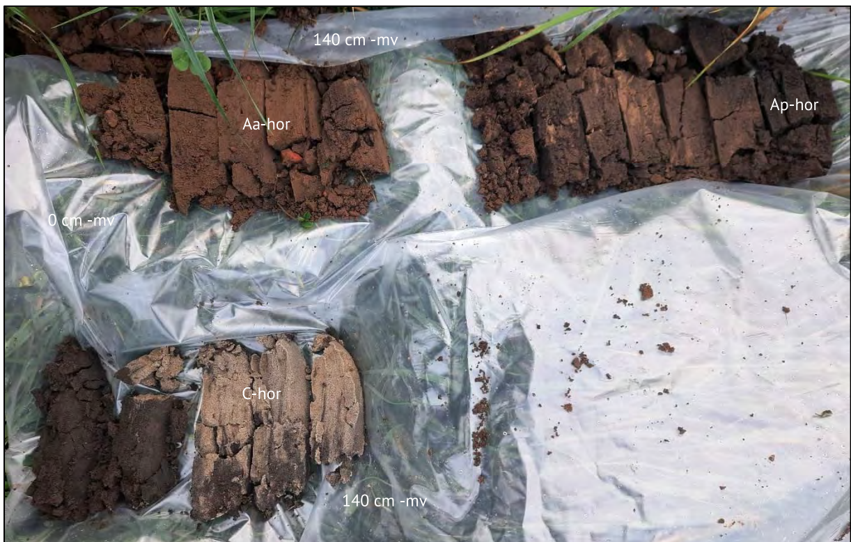
Figuur 11. Foto van boring 3 (Type III). De leesrichting is van linksboven naar rechtsonder (0 – 140 centimeter). (Foto: 20 december 2021).
