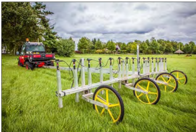
Figuur 3. Passieve non realtime oppervlakedetectie met het Vallon Multisondesysteem VXV16 en een staafdiagram waarop het maximale detectiebereik (m 1 - maaiveld) per kaliber is weergegeven.
