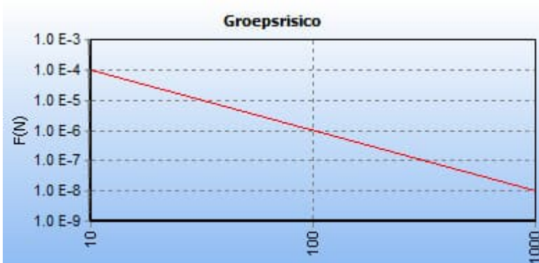
Afbeelding 12 fN-curve buisleiding A-526-deel-1, huidige situatie
